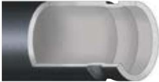
所示為壁厚40鋼管的滾制溝槽。管道內壁上形成的細微凹痕不會對壓力和流量造成太大的影響。
